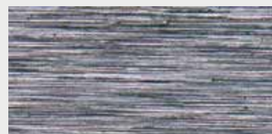
Brusný pás se zrnem 40 Krátká výrazná struktura čar, Drsný povrch, Kontrastní koncový brus
